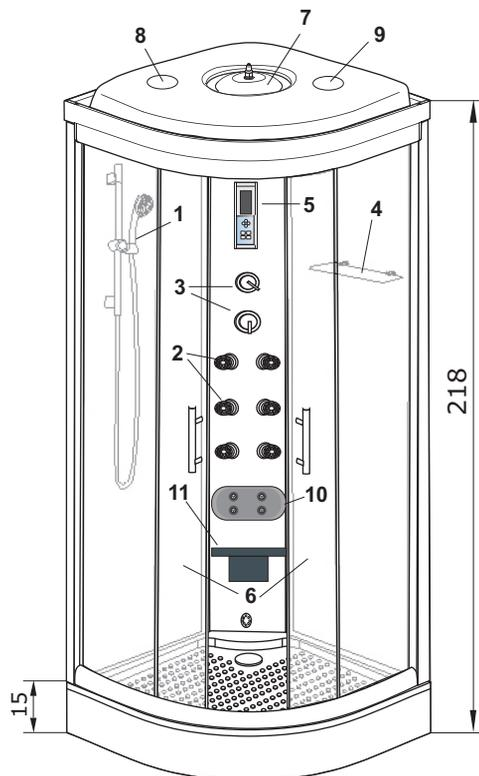
Para la conexión eléctrica es necesario una manguera de 3 x 2,5 mm de sección. Esta manguera tiene que ser de 1 a 2 metros de longitud. Se recomienda instalar 2 llaves de corte una para agua fría y otra para caliente.
