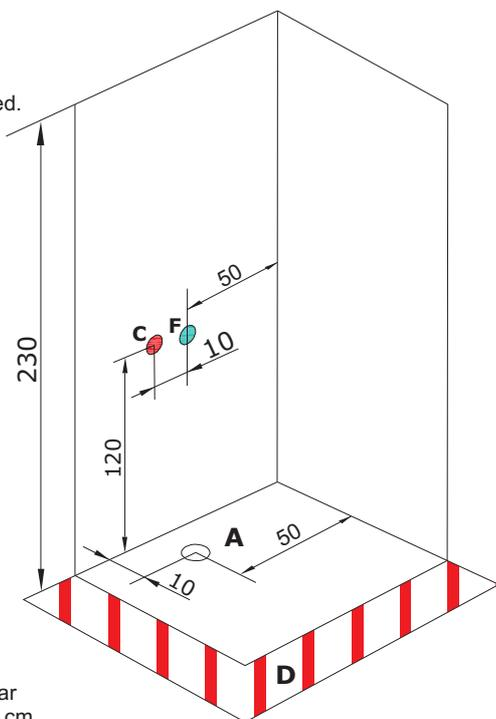
Es necesario guardar una distancia de 50 cm. de seguridad para poder montar la cabina. (D)
