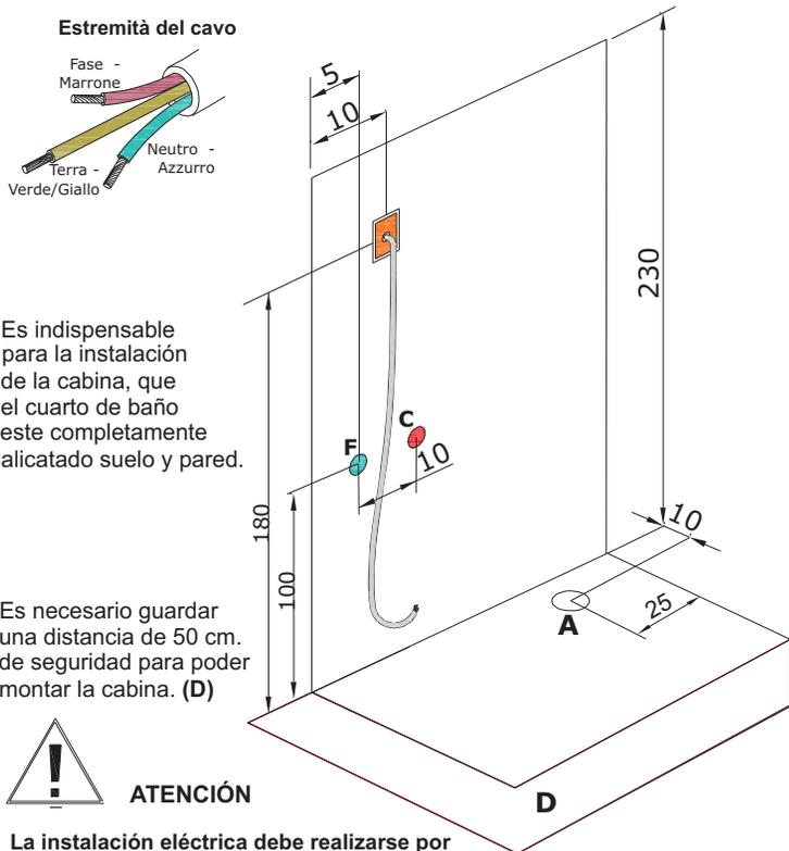
La instalación eléctrica debe realizarse por personal especializado, garantizar la conexión de la toma de tierra y la colocación de un diferencial de protección de 30mA. La conexión eléctrica debe realizarse mediante una caja de conexión estanca.
