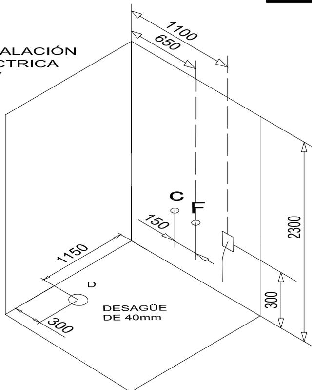
De la toma de corriente eléctrica debe salir una manguera de 3 x 4mm<sup>2</sup> de sección y 1 metro de largo.
