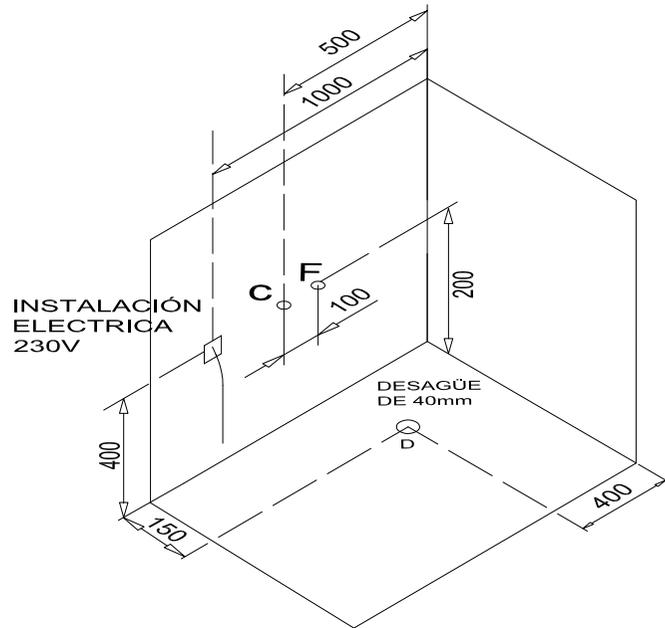
De la toma de corriente eléctrica debe salir una manguera de 3 x 2,5mm<sup>2</sup> de sección por 1 a 2 m de largo.
