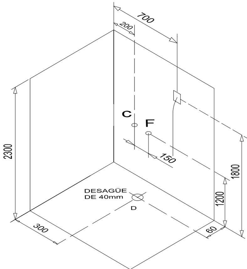
**De la toma de corriente eléctrica debe salir una manguera de 3 x 6mm<sup>2</sup> de sección por 1 a 2m de largo.**
