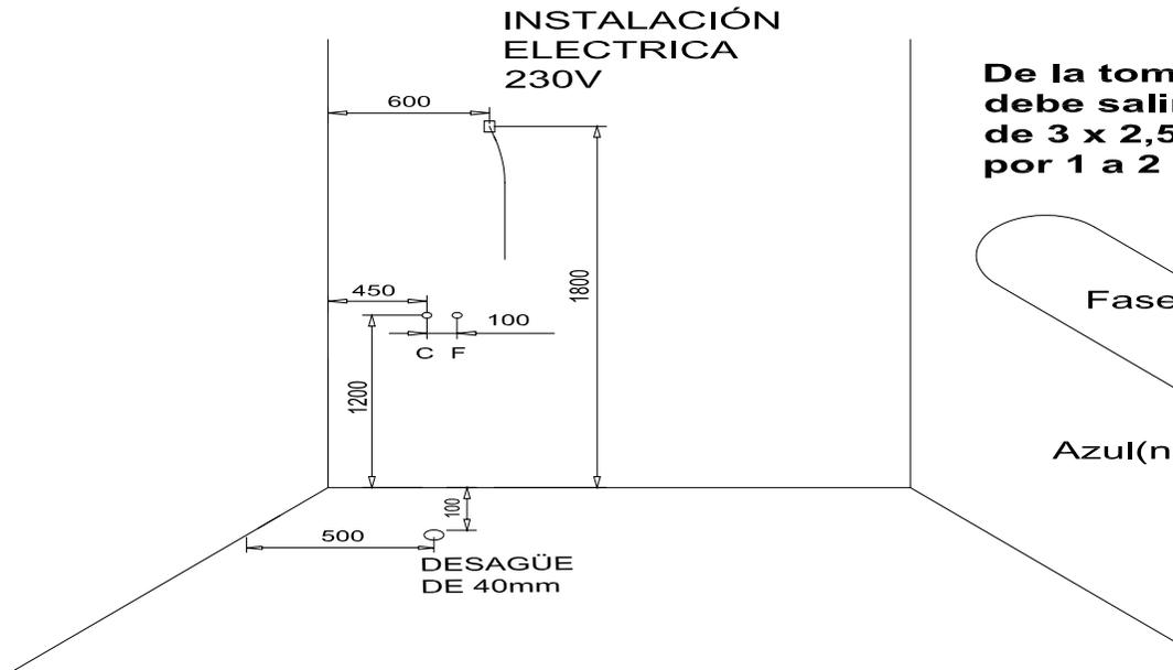
**De la toma de corriente debe salir una manguera de 3 x 2,5mm<sup>2</sup> de sección por 1 a 2 m de largo.**
