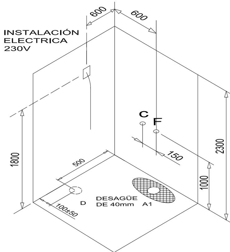
De la toma de corriente eléctrica debe salir una manguera de 3 x 2,5mm<sup>2</sup> de sección por 1 a 2 m de largo.
