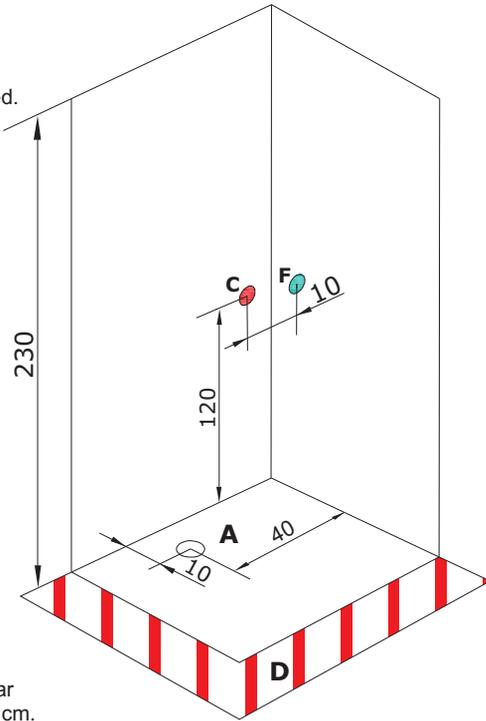
Es necesario guardar una distancia de 50 cm. de seguridad para poder montar la cabina. (D)
